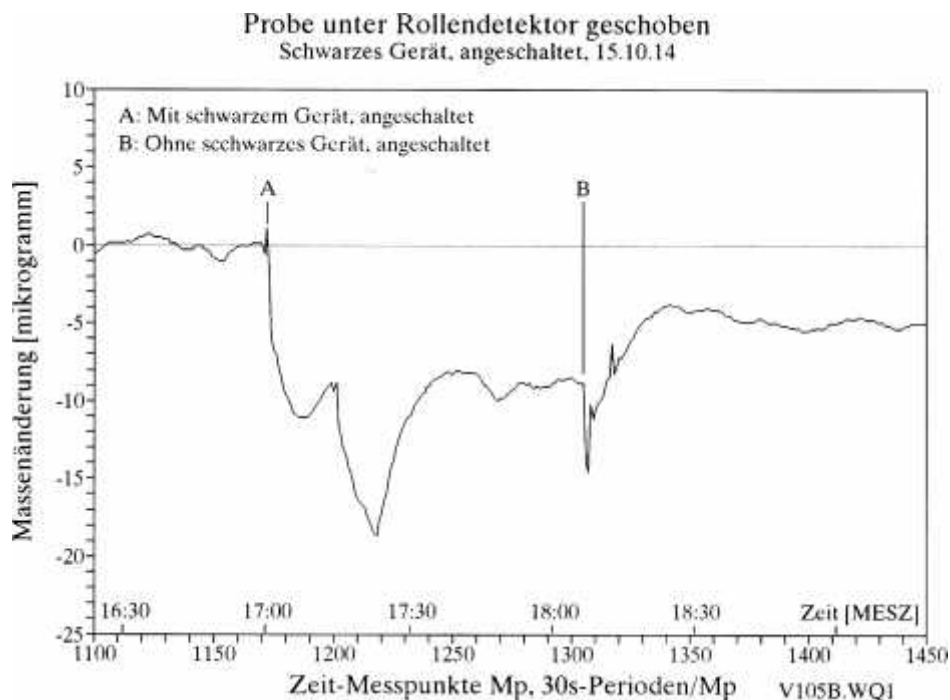
Abbildung 2: Gewichtsänderungen des Rollendetektors nach Unterschiebung der Testprobe (angeschaltetes schwarzes Gerät) aus ca. 15 cm Entfernung auf einen Abstand von wenigen Millimetern unter den Detektor im Test im Zeitintervall A bis B. Weiteres im Text.
